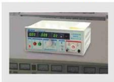
Test de alto voltaje
